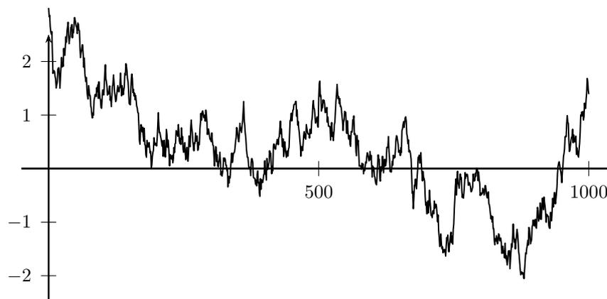
Abbildung 1: Trajektorie eines AR(1)-Prozesses mit Parametern  $\alpha = 0.8$  und  $\varepsilon^2 = 1.5$ .
